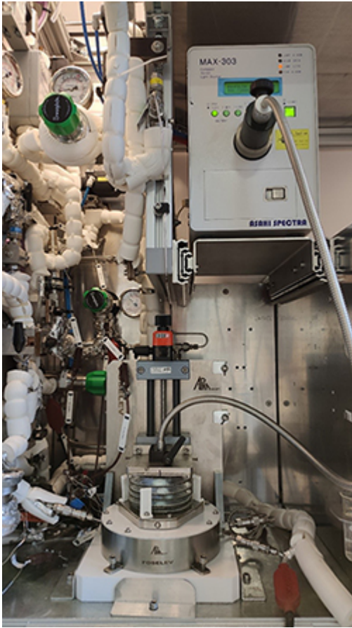
Figure : Pilote de laboratoire de photoconversion du CO 2 .
