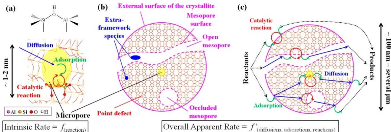
(a) Modèle de zéolite acide de Brønsted, limitée au micropore, en tenant compte des étapes de diffusion, d'adsorption et de réaction. (b) Schéma représentant les défauts et la nature de taille finie d'une cristallite de zéolite complexe. Un modèle sphérique est choisi arbitrairement. (c) Intégration de la diversité des sites et des étapes pour la définition de la vitesse de réaction apparente. Copyright 2023 American Chemical Society
