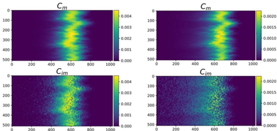
Figure 1: champs de concentration pour  $Da=1/8$  (gauche) et  $Da=1/40$  (droite).  $C_m$  représente la concentration dans la zone mobile et  $C_{im}$  la concentration dans la zone immobile
