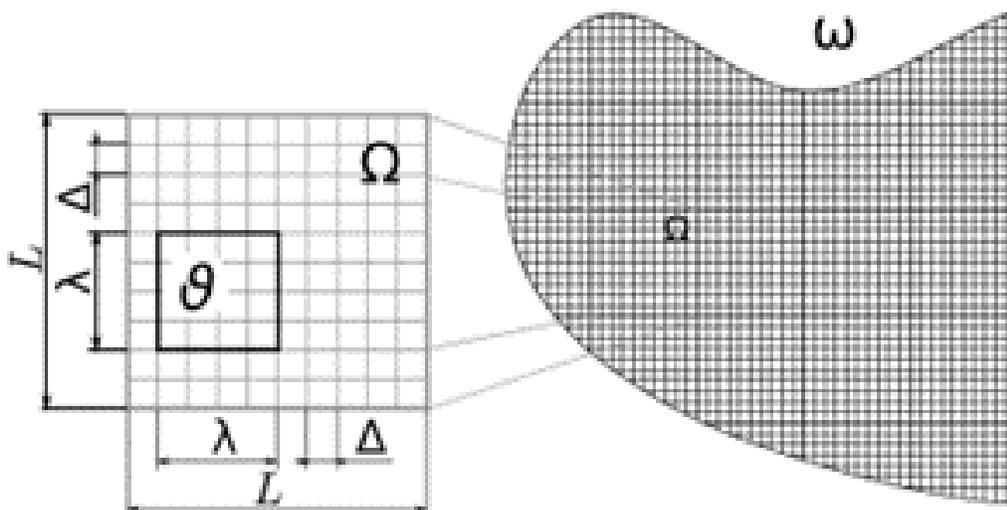
Figure 1 : le modèle fin est simplifié en agrégeant les mailles fines de taille  $D$  en mailles de taille  $\lambda > D$ . Pour garder le contrôle, la simulation est réalisée sur des sous volumes  $W$  et en faisant varier  $\lambda$  l'évolution de la distribution des conductivités peut être quantifiée en fonction de l'échelle de prise de moyenne. Cela permet d'identifier des comportements à grande échelle : percolant, non percolant, homogénéisable ou non etc...
