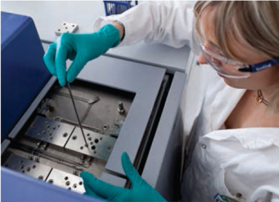
Chargement des réacteurs sur un équipement EHD.
