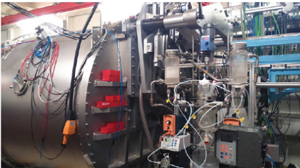
Installation du dispositif de synthèse sur la ligne SWING du synchrotron SOLEIL.
