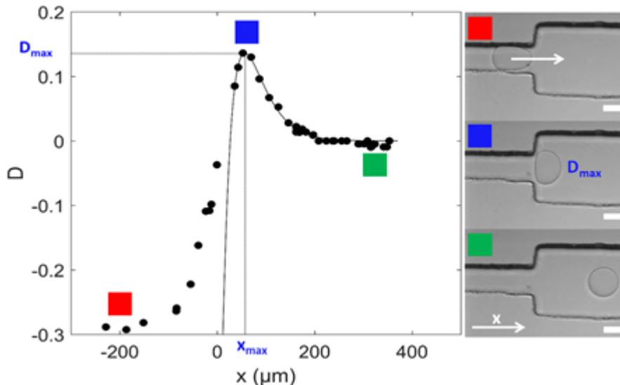
Déformation d'une goutte au passage d'une restriction microfluidique (en  $x = 0$ ).
