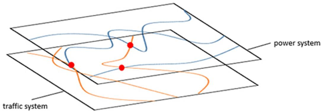
Principe de diagramme de superposition du système de circulation et du réseau électrique utilisé dans le modèle d'optimisation
